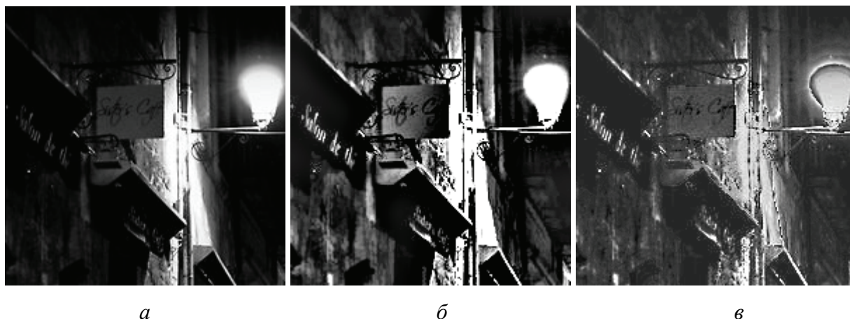
Рис. 3. Улучшение изображения: а – исходное изображение, б - Гаусс, в – алгоритм KNV
