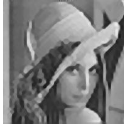
г) Интерполяция, основанная на регуляризации [23], MSE = 480.07
