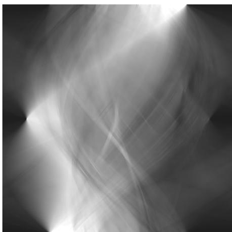
Рис. 3г. Синограмма рис. 3б (2048x2048)
