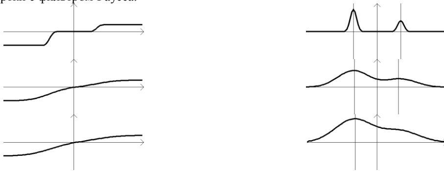
Рис. 4. Эффект маскирования и смещения контуров при гауссовом размытии. Слева: профили контуров, справа: значение градиента с отмеченными локальными максимумами. Верхний ряд: слабое размытие, средний: среднее размытие, нижний: сильное размытие.
