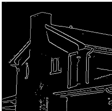
б) результат выделения базовых контуров: белым цветом обозначены базовые контуры, серым — контуры, прошедшие условие маскирования (1), но не являющиеся базовыми.
