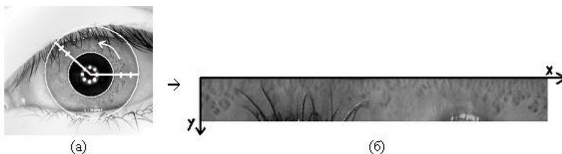
**Рисунок 5** - (а) - изображение глаза с введенной псевдополярной системой координат; (б) - нормализованное изображение радужной оболочки.
