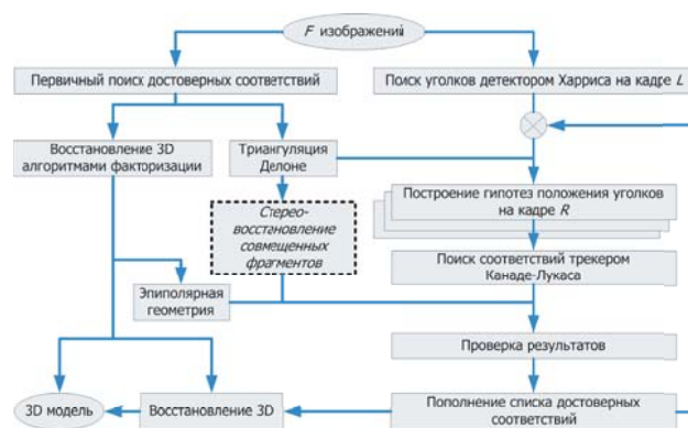
Рис. 1: Схема системы восстановления трехмерных сцен
