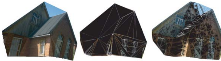
Рис. 3: Восстановленные трехмерные модели: Слева: алгоритм ИПП; в центре: уточнение ДХ и трекером КЛ; Справа: стерео.
