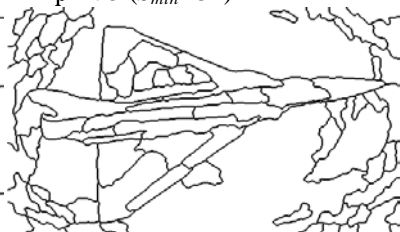
Рис. 13. Результат заливки R-изображения, представленного на рис. 7 ( S_{min}=128 )
